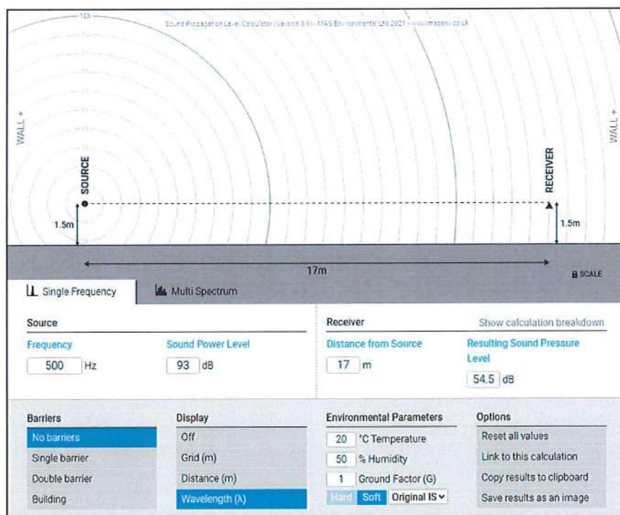
In cazul in care pe amplasament vor circula 2 camioane si 4 autoturisme, nivelul generat de zgomot va fi 54.5 dB, sub LMA inca de la distanta de 17 m de la punctul de emisie (centrul amplasamentului).
