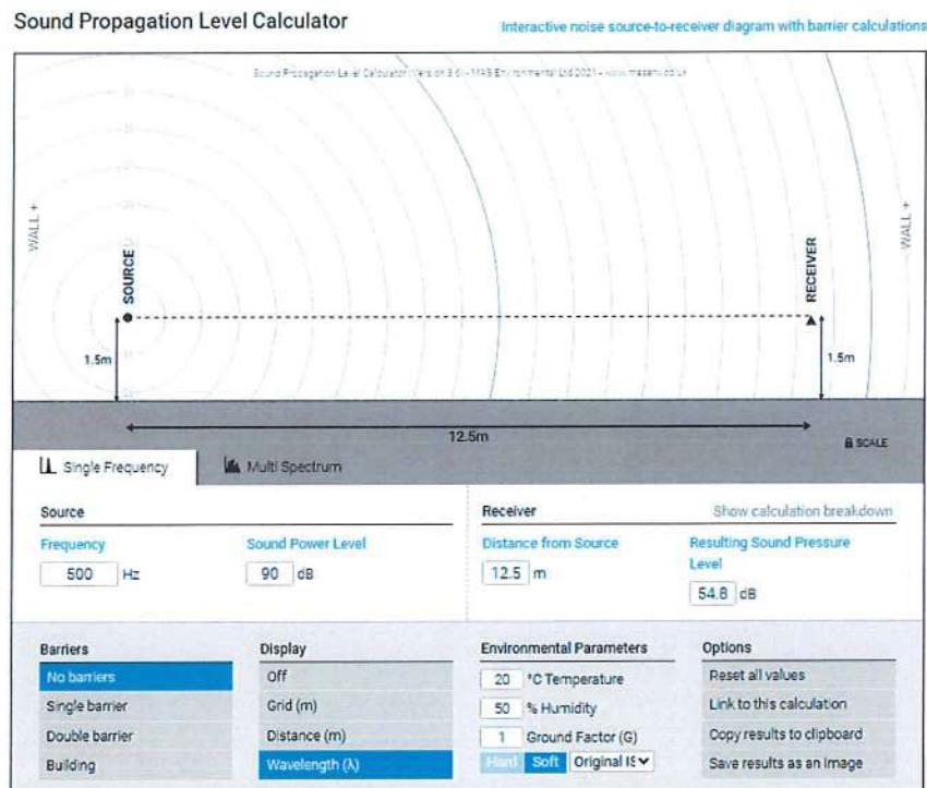
La distanta de 12.5 m de la punctul de emisie (centrul amplasamentului) nivelul de zgomot 54.8 dB se incadreaza in LMA
